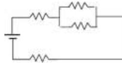
si pensi di determinare la resistenza equivalente : . Per comodità si supponga che ogni resistenza abbia un valore di  $10\Omega$ . La resistenza equivalente è la serie di due resistori con un parallelo di altre due resistenze. Utilizzando le due leggi precedentemente descritte si avrà
